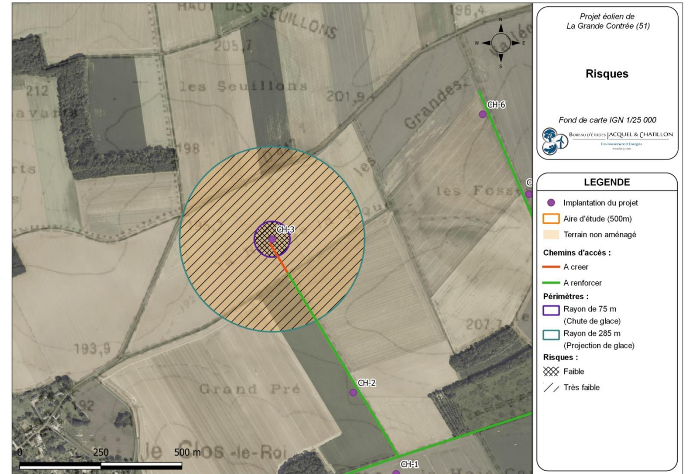
Carte 22 : Éolienne CH-3 – Risques liés à la chute et à la projection de glace (Source : BE Jacquiel et Chatillon)
